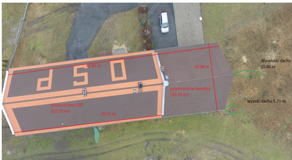
Zdjęcie 2. Stan obecny pokrycia dachowego – wymiary dachu
